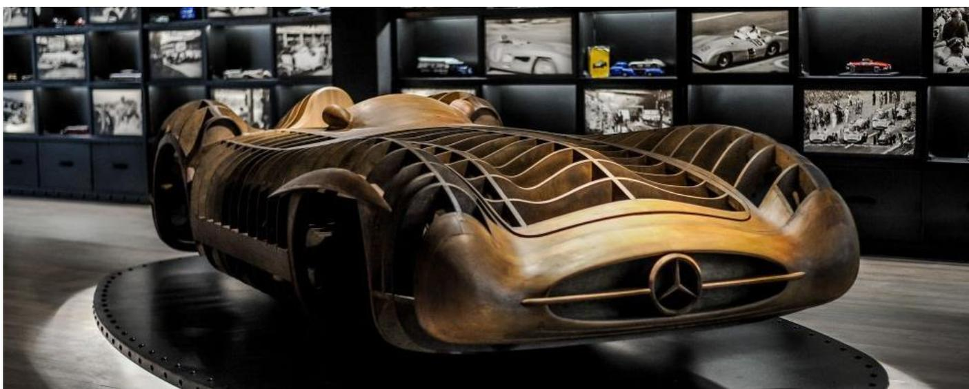
Réplica del molde sobre el que se construyó el Mercedes-Benz W 196 R de Fangio
